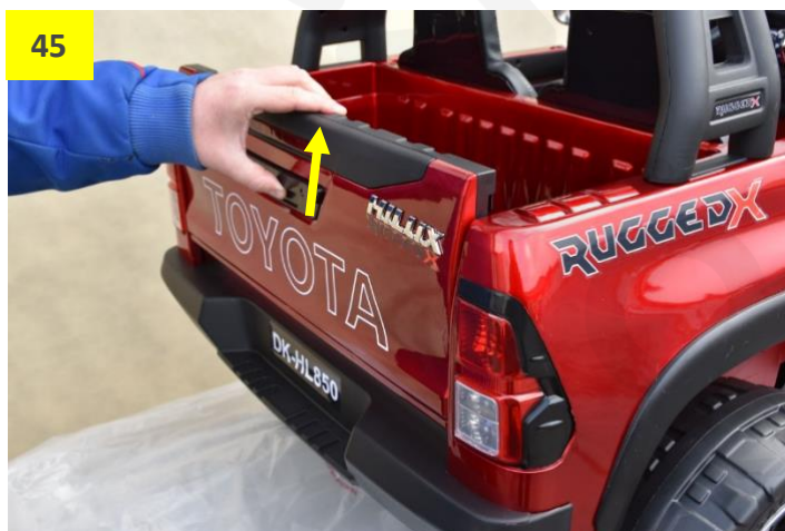
Obr. 45 a 46: Otvírání a zavírání zadního čela. Při otvírání zadní čelo nejdříve povytáhněte směrem nahoru a poté otevřete směrem k sobě.
