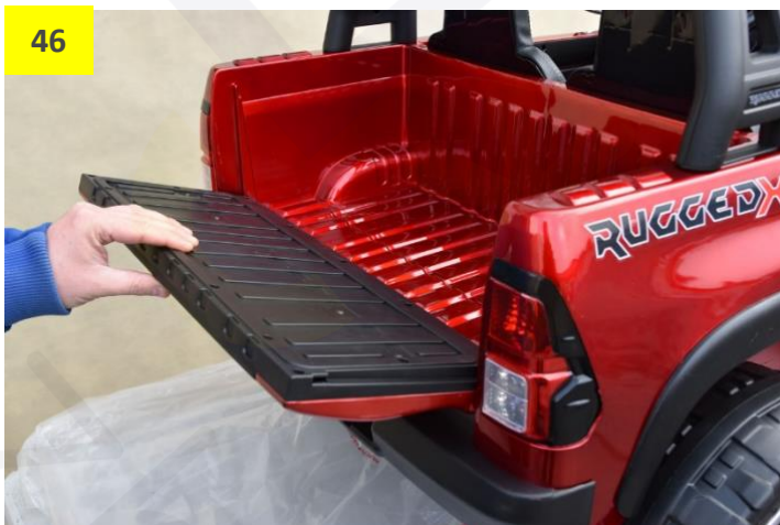
Obr. 45 a 46: Otvírání a zavírání zadního čela. Při otvírání zadní čelo nejdříve povytáhněte směrem nahoru a poté otevřete směrem k sobě.
