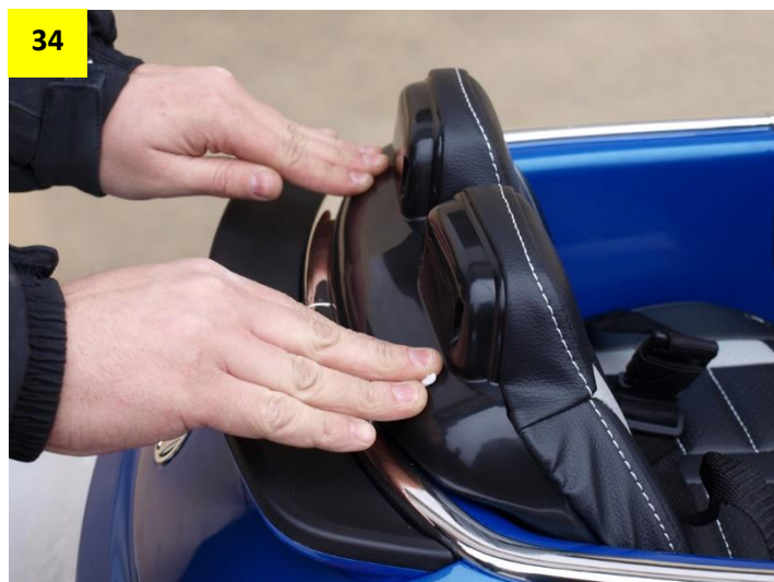
Obr. 34 a 35: Nyní nasadte sedačku – plastové výstupky na zadní straně sedačky musí zapadnout do otvorů v autíčku.
