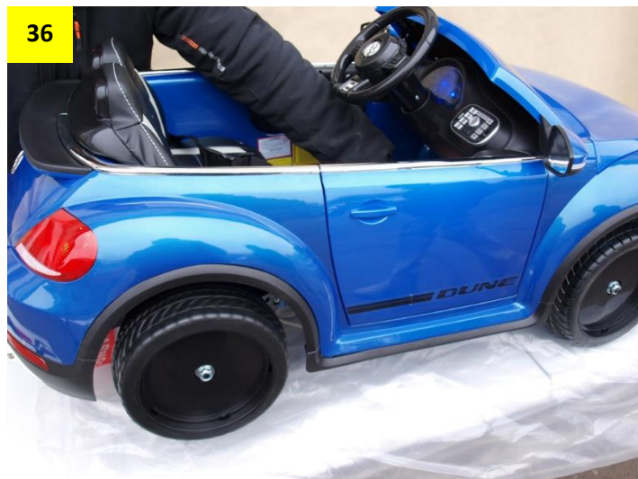
Obr. 36: Autíčko rukou nadzvedněte a stlačte rukou pedál, abyste ověřili správné otáčení kol vpřed/vzad.
