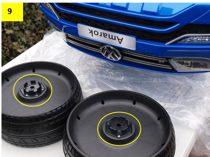
Obr. 10: Do kol zasadte plastové válečky.
