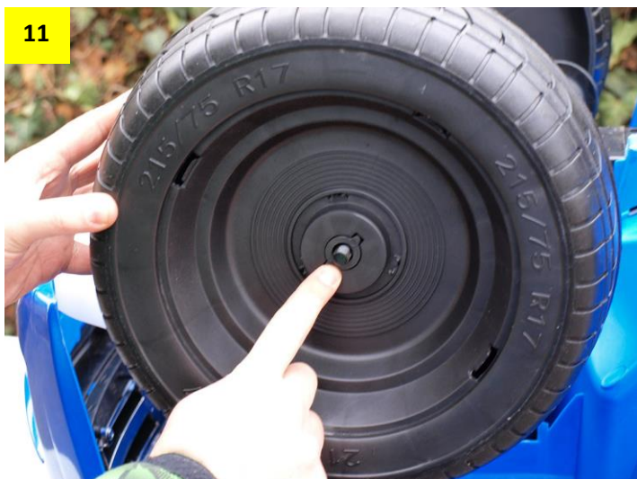
Obr. 12: K oběma kolům opět přiložte kovové podložky.
