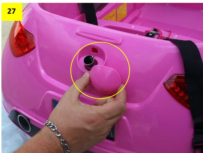
Obr. 28: Zapojte konektor volantu. Pozor: po zapojení konektoru volant stále držte, aby nedošlo k jeho pádu a následnému přetržení kabelů.
