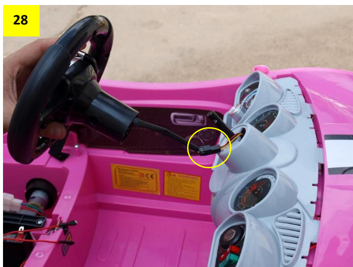
Obr. 28: Zapojte konektor volantu. Pozor: po zapojení konektoru volant stále držte, aby nedošlo k jeho pádu a následnému přetržení kabelů.
