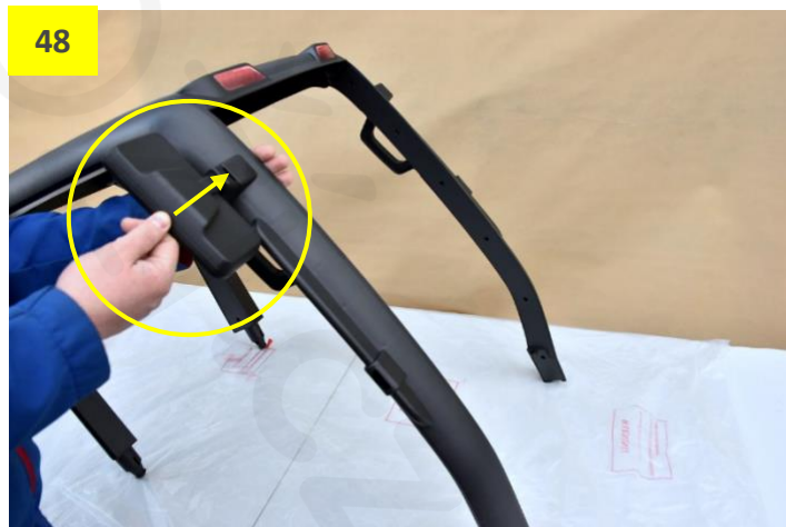
Obr. 48: Zpětné zrcátko nasadte a zatlačte nadoraz do otvoru rámu střechy.
