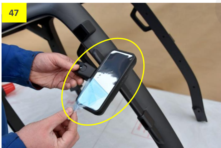
Obr. 48: Zpětné zrcátko nasadte a zatlačte nadoraz do otvoru rámu střechy.
