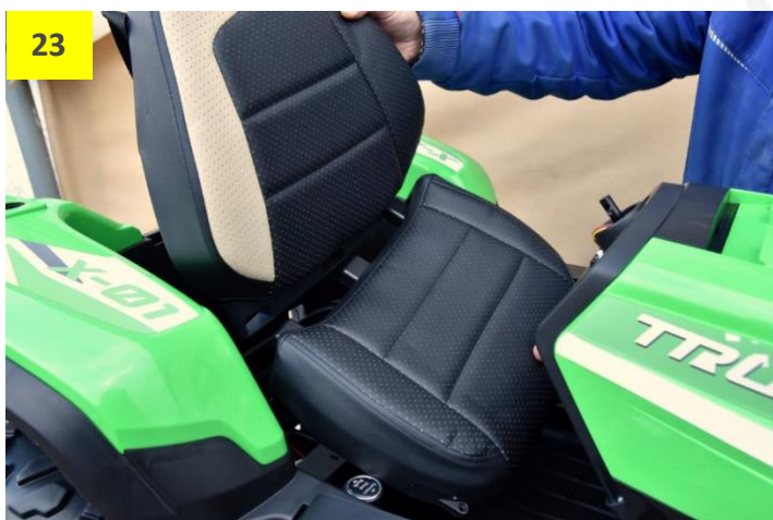
Obr. 24: Zadní část opěradla nasadte do otvorů v karoserii.
