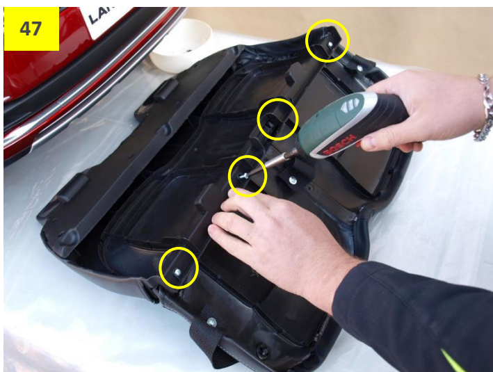
Obr. 48: Vyjměte ze sedačky plastový otočný kolík (na levé i pravé straně sedačky).
