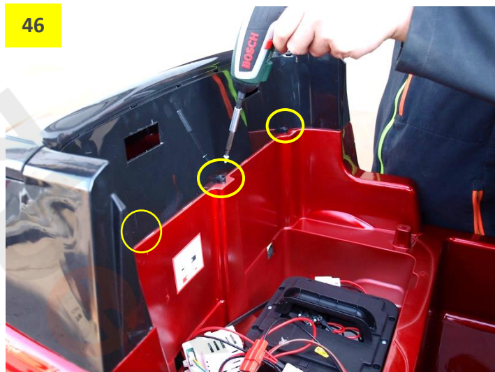
Obr. 48: Vyjměte ze sedačky plastový otočný kolík (na levé i pravé straně sedačky).
