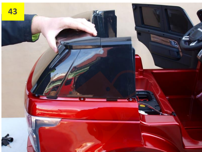
Obr. 45: Při nasazování zadního okna si autíčko přidržte zespod.
