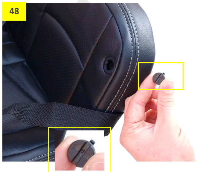
Obr. 48: Vyjměte ze sedačky plastový otočný kolík (na levé i pravé straně sedačky).
