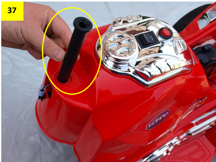
Obr. 39 a 40: Před nasazením doporučujeme kroužek namazat vazelínou, aby v otvoru lépe držel.
