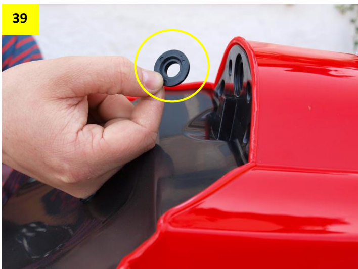
Obr. 39 a 40: Před nasazením doporučujeme kroužek namazat vazelínou, aby v otvoru lépe držel.
