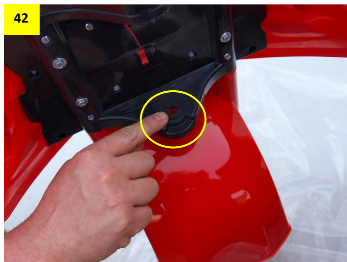
Obr. 41 a 42: Stejně tak doporučujeme namazat vazelínou i tento kroužek. V otvoru pak bude držet lépe.
