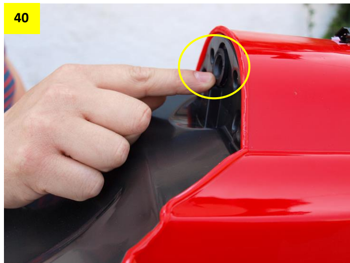
Obr. 39 a 40: Před nasazením doporučujeme kroužek namazat vazelínou, aby v otvoru lépe držel.
