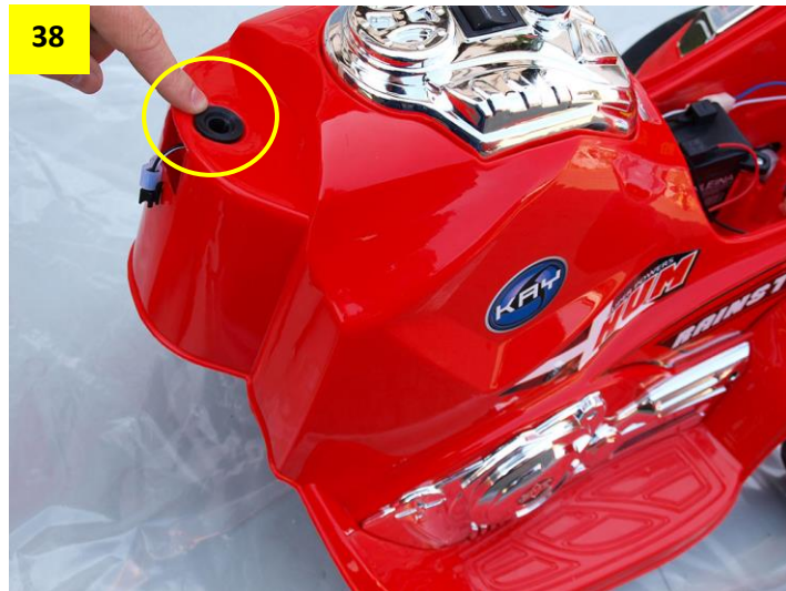
Obr. 39 a 40: Před nasazením doporučujeme kroužek namazat vazelínou, aby v otvoru lépe držel.
