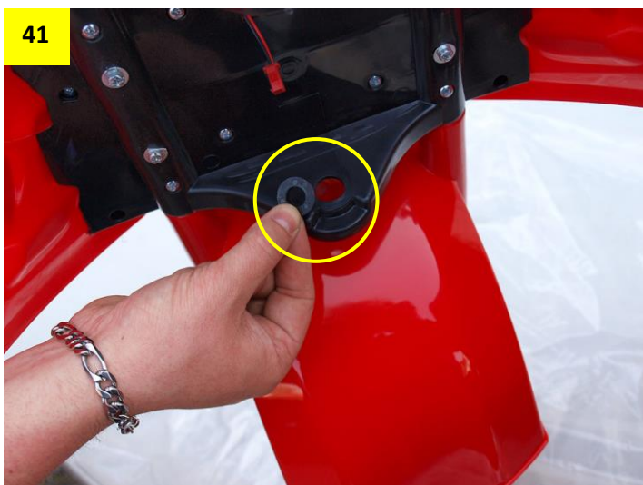
Obr. 41 a 42: Stejně tak doporučujeme namazat vazelínou i tento kroužek. V otvoru pak bude držet lépe.
