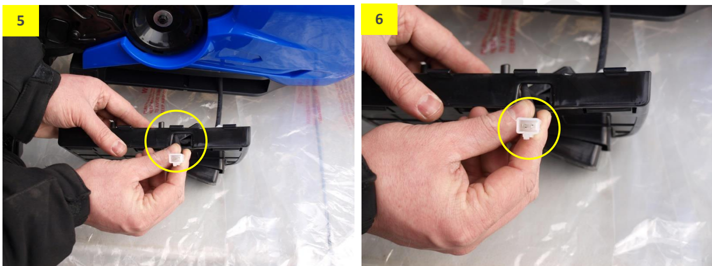
Obr. 6: Překontrolujte kovové konektory uvnitř zástrčky – musí být rovně a uprostřed . Jsou-li vychýlené ke stranám, narovnejte je prosím prstem. Zástrčky do sebe musí jít následně snadno zastrčit.
