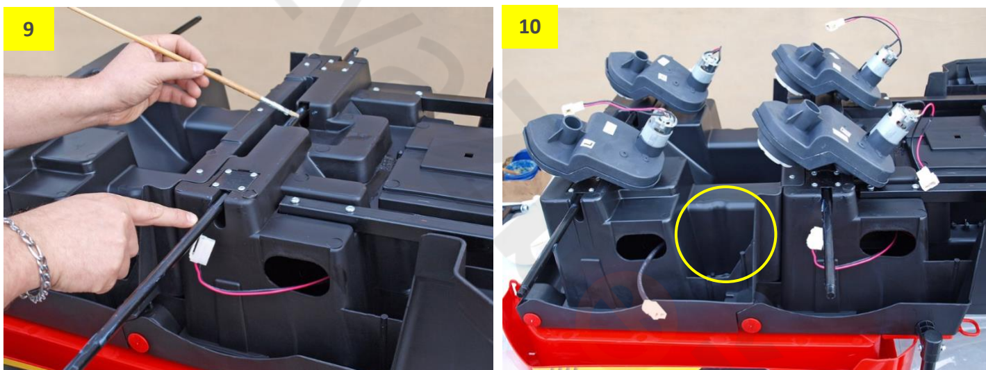
Obr. 11: Nasadte motory na zadní osy (R motory vpravo, L motory vlevo) a propojte konektory motorů.
