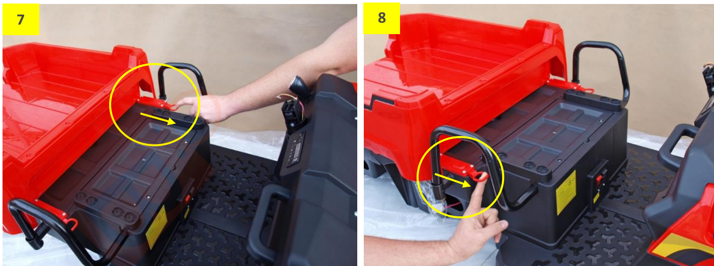
Obr. 9: Prostrčte zadní osy a namažte je vazelínou po celé délce.
