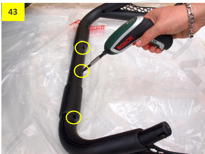
Obr. 44: Nyní nasadte vrchní rám sedačky. Rám je potřeba opatrně zasadit až nadoraz.
