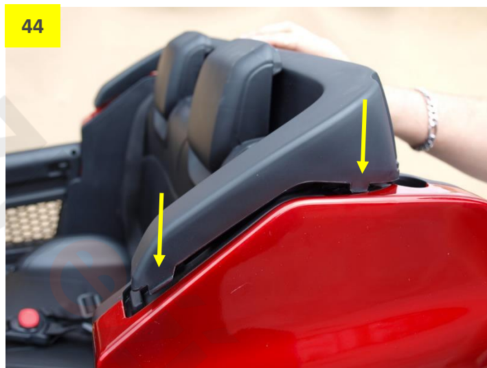
Obr. 44: Nyní nasadte vrchní rám sedačky. Rám je potřeba opatrně zasadit až nadoraz.
