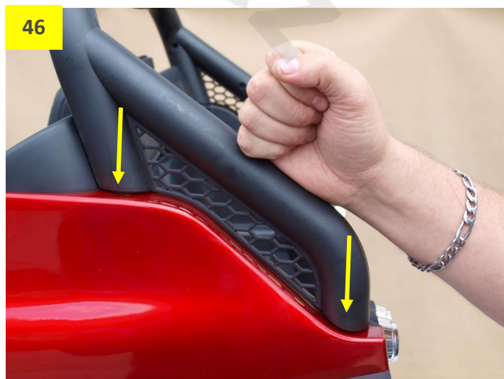
Obr. 45: Vrchní rám sedačky přišroubujte na obou stranách pomocí středních šroubků.
