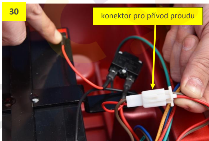
Obr. 29: Pro zapojení baterie je potřeba napojit červený kabel vedoucí od resetovací pojistky na červené plus na baterii.
