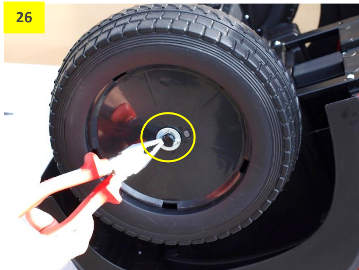
Obr. 25 a 26: Zajištění kol – vnější kovová podložka a závlačka. Závlačku ohněte, aby při jízdě nevypadla.
