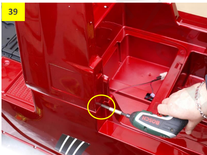
Obr. 41: Zadní díl kabiny přišroubujte.
