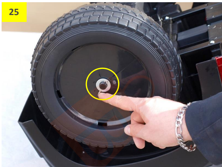
Obr. 25 a 26: Zajištění kol – vnější kovová podložka a závlačka. Závlačku ohněte, aby při jízdě nevypadla.
