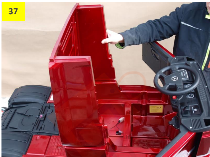
Obr. 39 a 40: Zadní díl kabiny přišroubujte.
