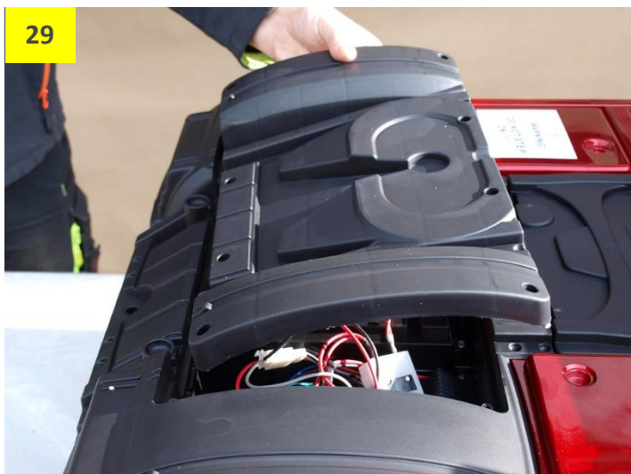
Obr. 29 a 30: Nasadte plastový kryt a přišroubujte ho.
