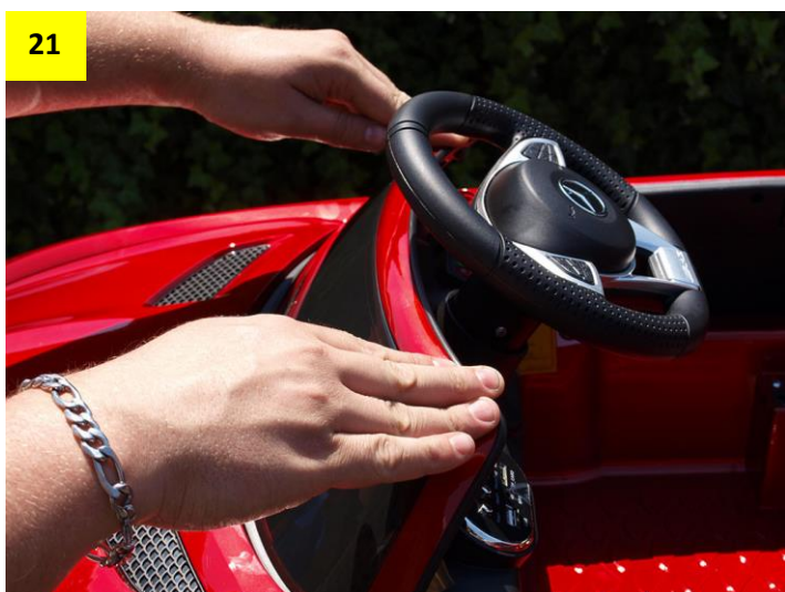
Obr. 21 a 22: Nasadte přední okno. Okno musí zapadnout nadoraz.
