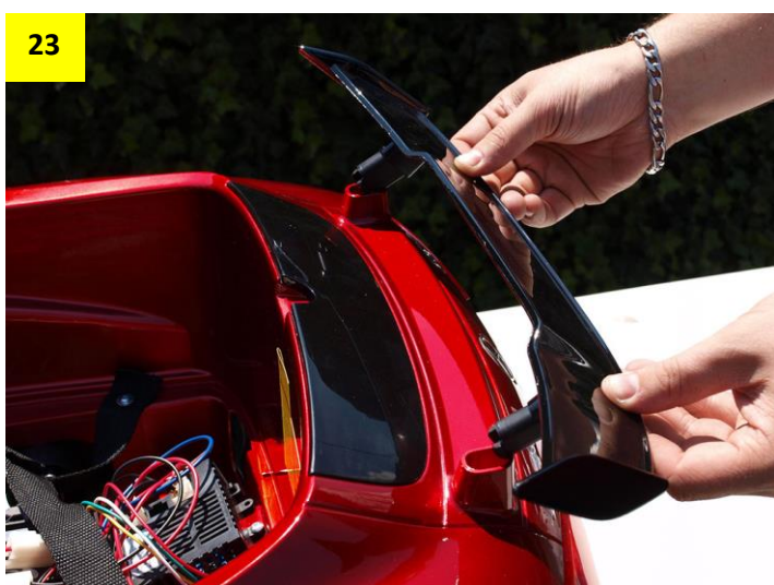
Obr. 23 a 24: Nyní nasadte zadní křídlo.
