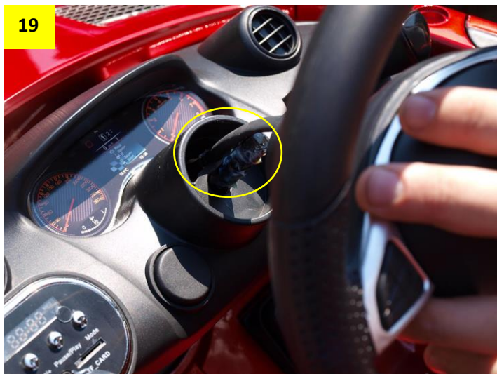
Obr. 19: Zapojený konektor spolu s kabely srovnejte a zastrčte do otvoru nad řízením.
