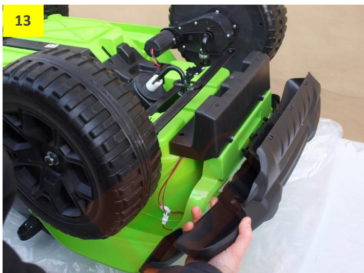
Obr. 13-16: Nasazení předního nárazníku
