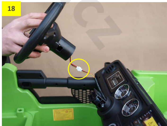
Obr. 18: Zapojte konektor volantu. Pozor – volant po zapojení stále držte, aby nedošlo k jeho pádu a případnému přetržení kabelů.
