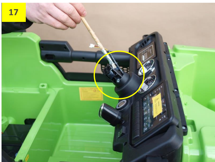
Obr. 18: Zapojte konektor volantu. Pozor – volant po zapojení stále držte, aby nedošlo k jeho pádu a případnému přetržení kabelů.
