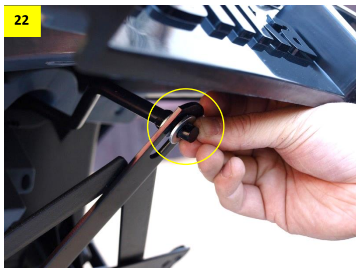
Obr. 21,22: Na spodní (zahnutý) konec tyče řízení nasadíte nejdříve kovovou podložku a poté zasuňte tyč do otvoru přední nápravy.
