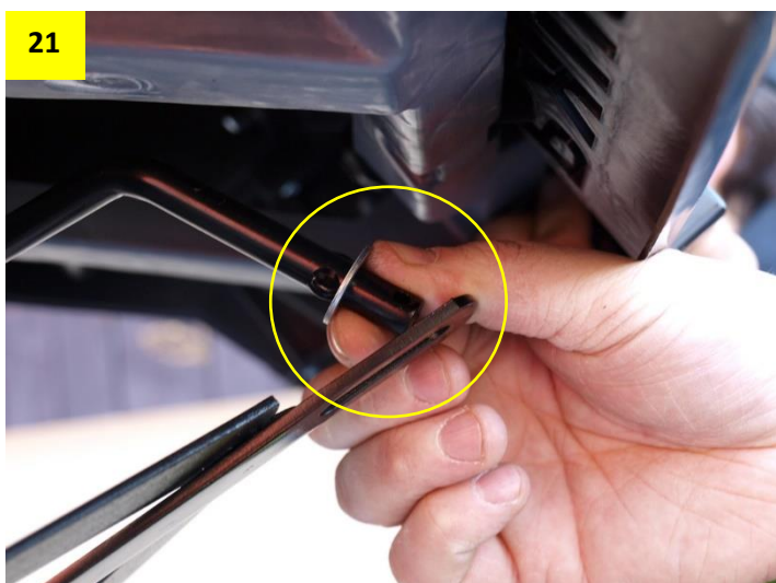
Obr. 23: Nasadíte druhou kovovou podložku.
