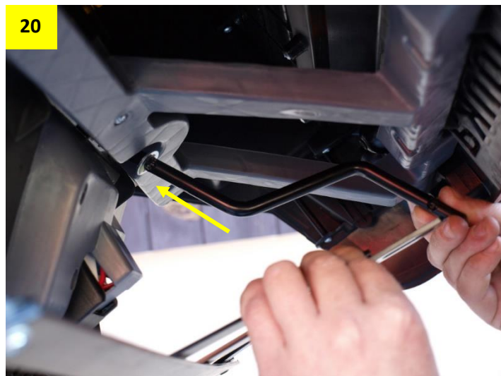
Obr. 21,22: Na spodní (zahnutý) konec tyče řízení nasadíte nejdříve kovovou podložku a poté zasuňte tyč do otvoru přední nápravy.
