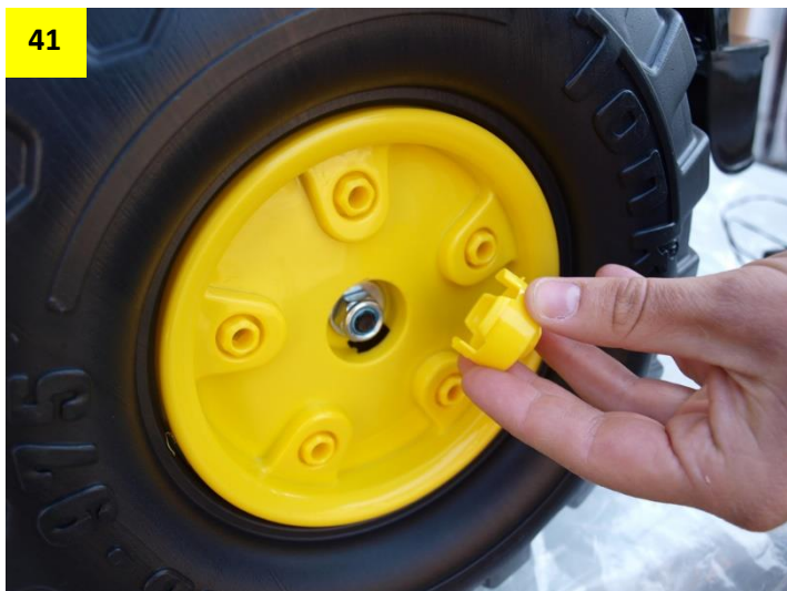
Obr. 41,42: Nasaďte ozdobné středové krytky kol.
