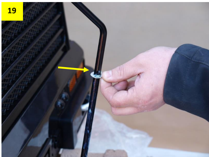
Obr. 21,22: Na spodní (zahnutý) konec tyče řízení nasadíte nejdříve kovovou podložku a poté zasuňte tyč do otvoru přední nápravy.
