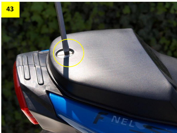
Obr. 43: Pomocí otočného kolíčku zajistíte sedačku.
