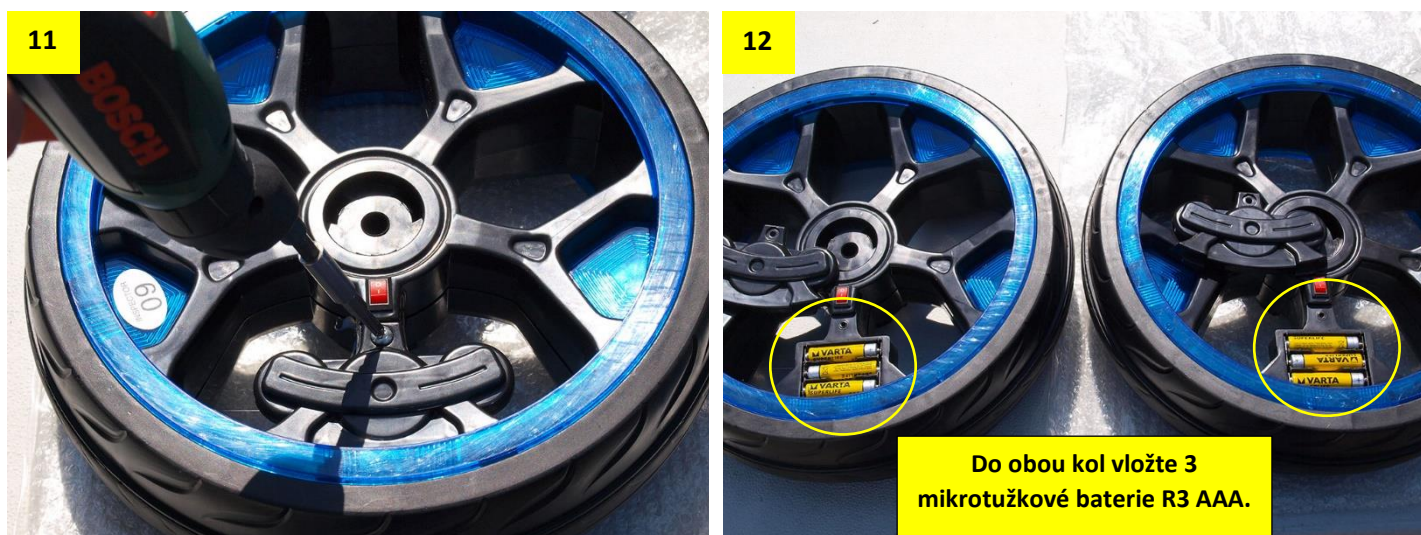
Obr. 11 a 12: Z obou kol odšroubujte kryty baterií a vložte do nich 3 mikrotužkové baterie R3 AAA. Při vkládání baterií zkontrolujte správnou polaritu + a -. Kryty baterií poté přišroubujte zpět.
