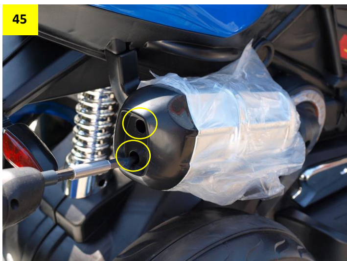
Obr. 45-47: Pro snadnější odstranění igelitových sáčků odšroubujte zadní část výfuků. Zadní část poté přišroubujte zpět.
