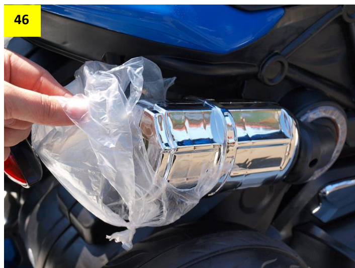
Obr. 45-47: Pro snadnější odstranění igelitových sáčků odšroubujte zadní část výfuků. Zadní část poté přišroubujte zpět.
