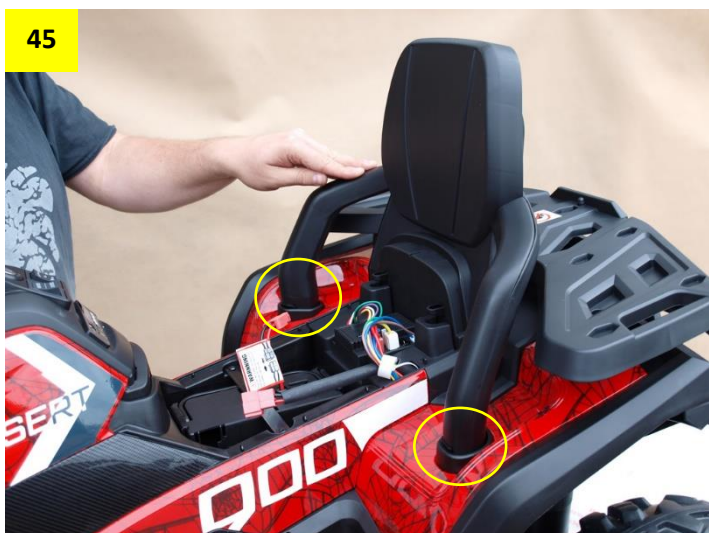
Obr. 45 a 46: Nasadte opěradlo sedačky. Opěradlo musí zapadnout nadoraz, během jeho nasazování si čtyřkolku podepřete zespod rukou jako na obrázku.
