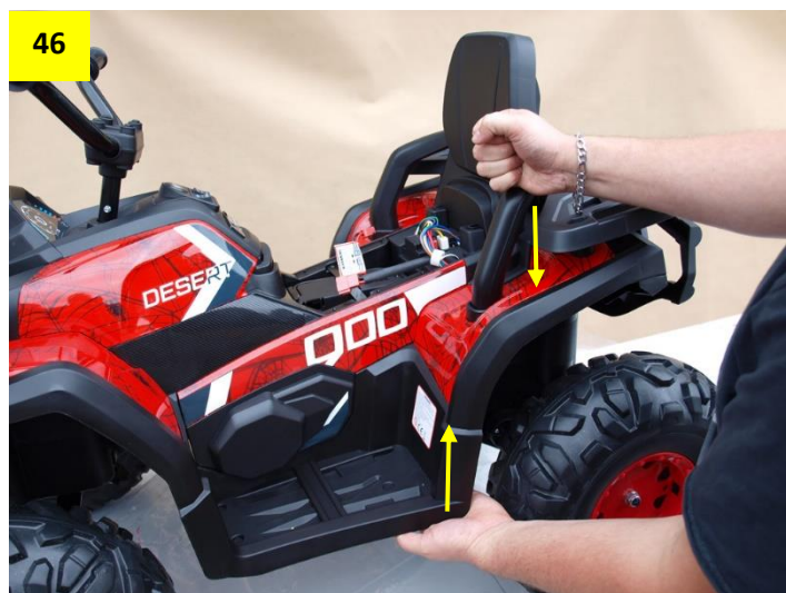
Obr. 45 a 46: Nasadte opěradlo sedačky. Opěradlo musí zapadnout nadoraz, během jeho nasazování si čtyřkolku podepřete zespod rukou jako na obrázku.
