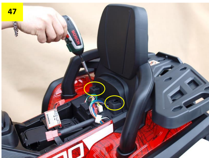
Obr. 48: Překontrolujte konektory pro zapojení baterie – mosazné packy v zástrčce musí být rovně a uprostřed. Jsou-li vychýlené ke stranám, narovnejte je prosím prstem.
