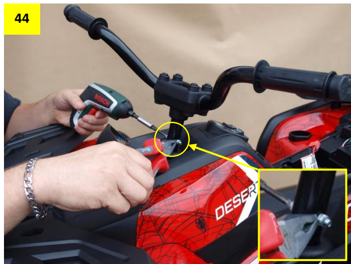
Obr. 45 a 46: Nasadte opěradlo sedačky. Opěradlo musí zapadnout nadoraz, během jeho nasazování si čtyřkolku podepřete zespod rukou jako na obrázku.
