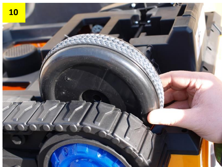
Obr. 11,12: Kolo nasadíte na osu, nasadíte podložky a zajistíte závlačkou.
