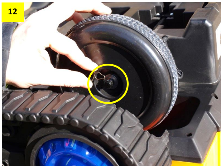
Obr. 11,12: Kolo nasadíte na osu, nasadíte podložky a zajistíte závlačkou.
