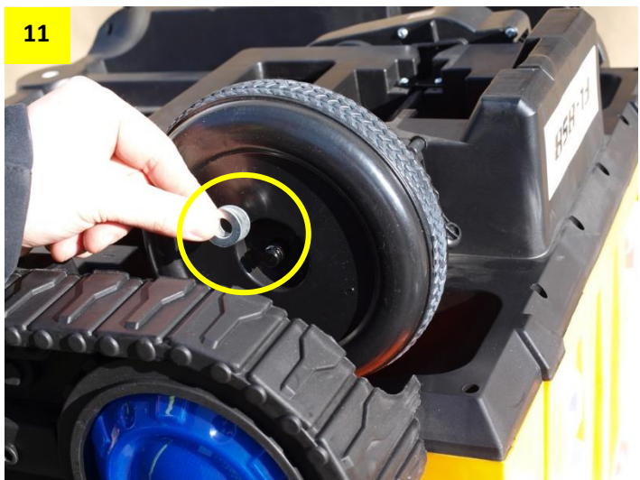
Obr. 11,12: Kolo nasadíte na osu, nasadíte podložky a zajistíte závlačkou.
