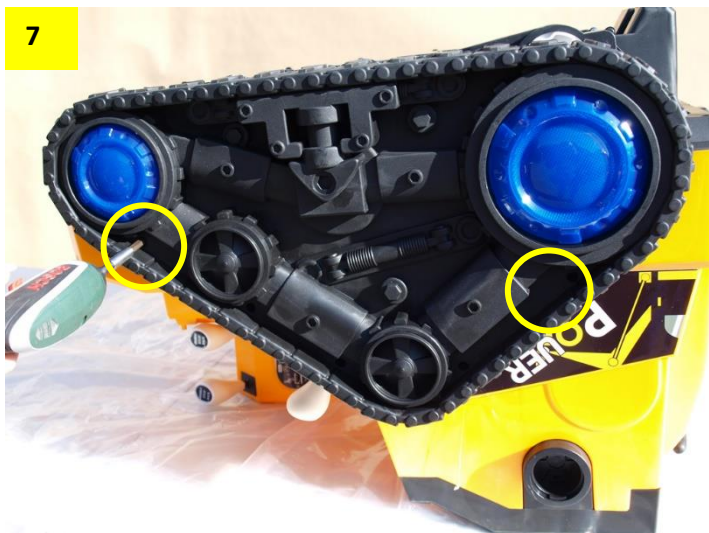
Obr. 8: Osu namažte vazelínou nebo olejem.
