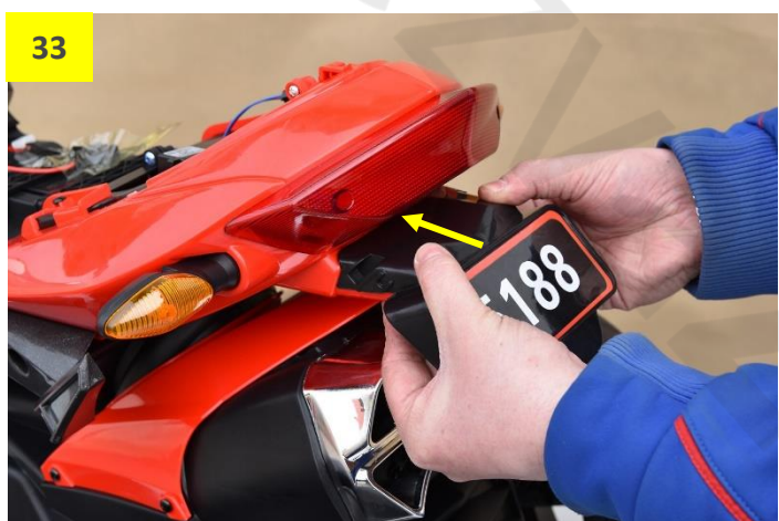
Obr. 33 a 34: Nasaďte zadní držák značky a přišroubujte.
