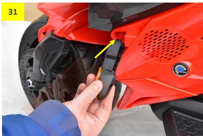
Obr. 31 a 32: Nasaďte blinkry.
