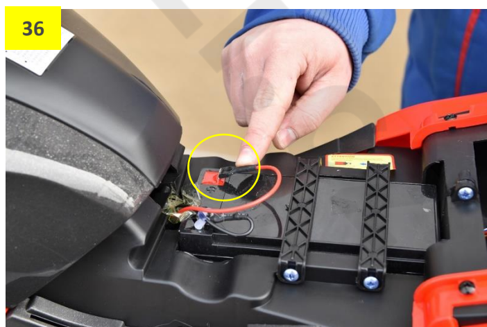
Obr. 35 a 36: Zapojení baterie – zapojte červený kabel na červený kontakt baterie. Zkontrolujte, zda je konektor pevně připojen ke kontaktu baterie. Pokud je volný zmáčkněte ho nepatrně kleštěmi a znovu nasaďte.
