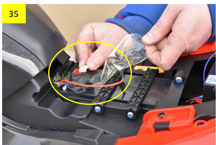
Obr. 35 a 36: Zapojení baterie – zapojte červený kabel na červený kontakt baterie. Zkontrolujte, zda je konektor pevně připojen ke kontaktu baterie. Pokud je volný zmáčkněte ho nepatrně kleštěmi a znovu nasaďte.
