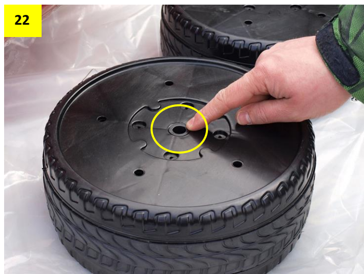
Obr. 23: Přední náprava: Na pravou i levou osu nasadíte kovové podložky. Obě osy poté namažte vazelínou nebo olejem.
