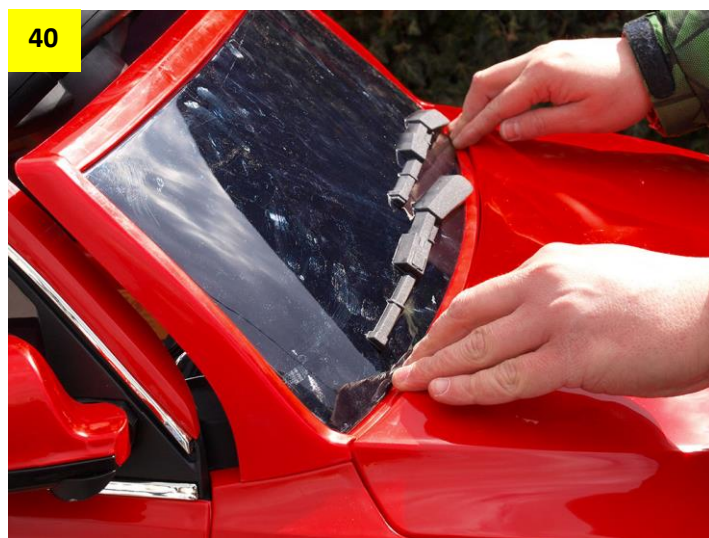
Obr. 39 a 40: Nasazení předního okna. Při jeho nasazování autíčko podpírejte zespod jako na obrázku.
