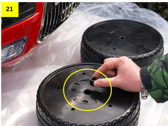
Obr. 21 a 22: Do předních kol vložte plastové válečky jako na obrázku.
