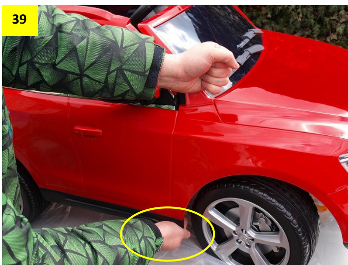
Obr. 39 a 40: Nasazení předního okna. Při jeho nasazování autíčko podpírejte zespod jako na obrázku.
