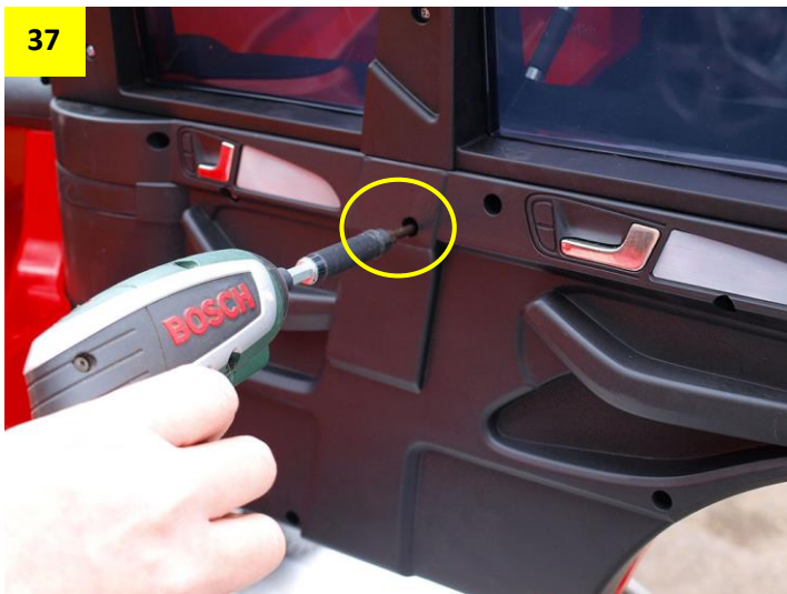
Obr. 39 a 40: Nasazení předního okna. Při jeho nasazování autíčko podpírejte zespod jako na obrázku.
