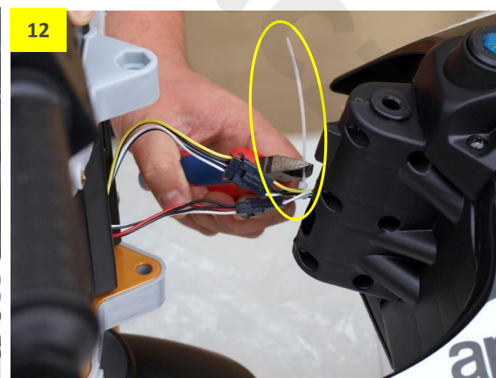
Obr. 12: Kleštěmi (případně nůžkami) odstříhnete přečuhující stahovací pásek.
