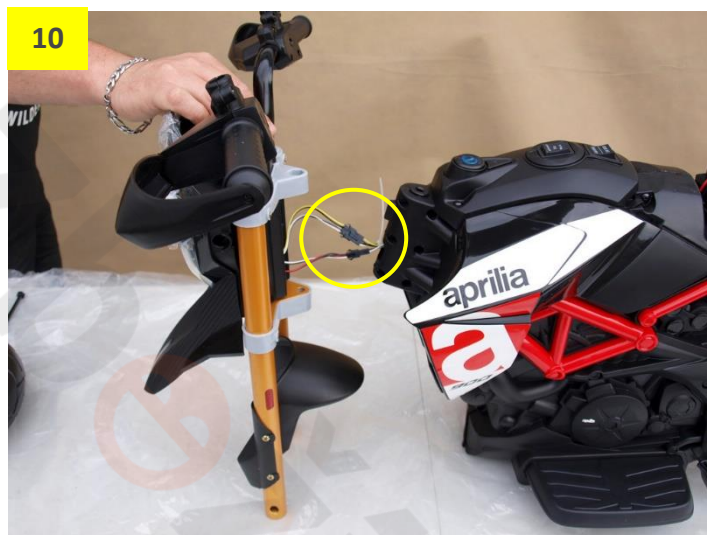
Obr. 10: Nyní zapojte konektory od ovládacího panelu řídítek s konektory vedoucími z trupu motorky. Pozor: Po zapojení konektorů řídítka stále držte, aby nedošlo k jejich pádu a případnému přetržení kabelů!
