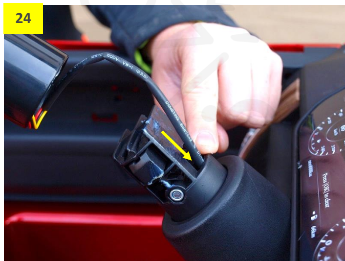
Obr. 24: Kabel s konektorem srovnejte a opatrně zasuňte do otvoru nad řízením. Současně nasazujte volant.
