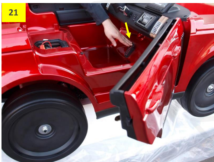
Obr. 23: Připravte si volant. Propojte konektor volantu.
