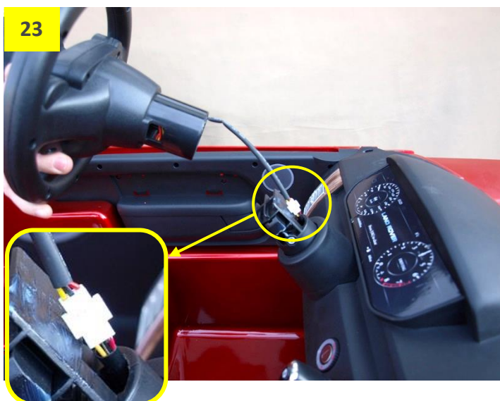
Obr. 24: Kabel s konektorem srovnejte a opatrně zasuňte do otvoru nad řízením. Současně nasazujte volant.
