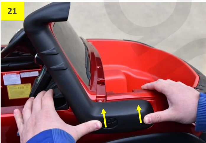
Obr. 21 a 22: Nasadte plastovou imitaci sání motoru a přišroubujte ji.
