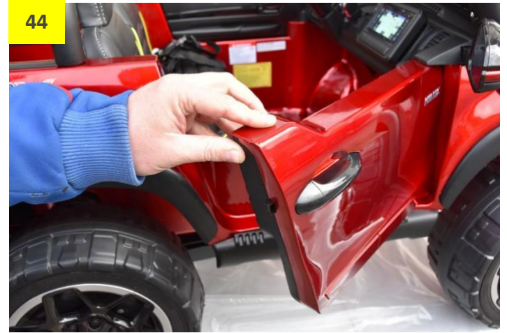
Obr. 45 a 46: Otevírání a zavírání zadního čela. Při otevírání zadní čelo nejdříve povytáhněte směrem nahoru a poté otevřete směrem k sobě.
