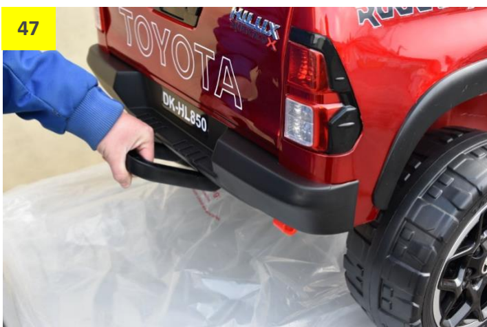
Obr. 47: Zadní výklopné madlo pro ruční tažení vozítka. Obr. 48: Nabíjecí zásuvka.
