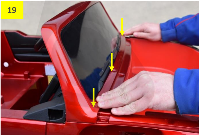
Obr. 19 a 20: Nasadte přední okno. Okno srovnajte a zatlačte nadoraz do karoserie. Poté okno přišroubujte.
