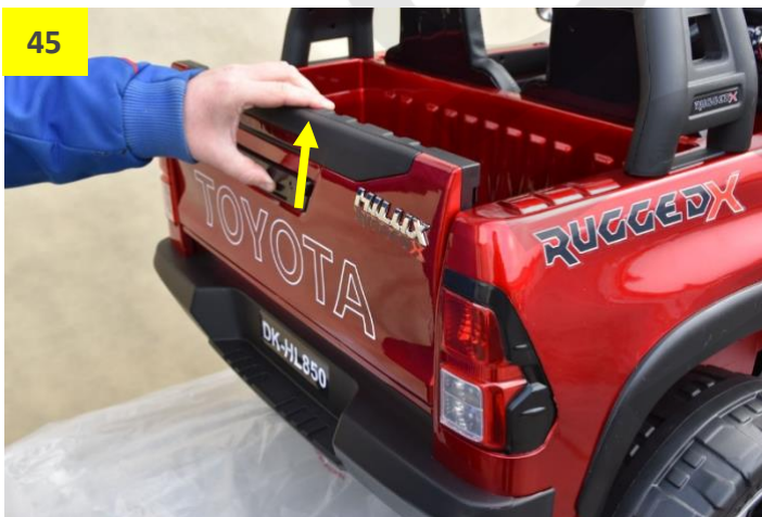
Obr. 45 a 46: Otevírání a zavírání zadního čela. Při otevírání zadní čelo nejdříve povytáhněte směrem nahoru a poté otevřete směrem k sobě.
