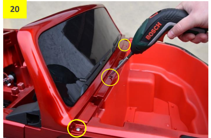
Obr. 19 a 20: Nasadte přední okno. Okno srovnajte a zatlačte nadoraz do karoserie. Poté okno přišroubujte.
