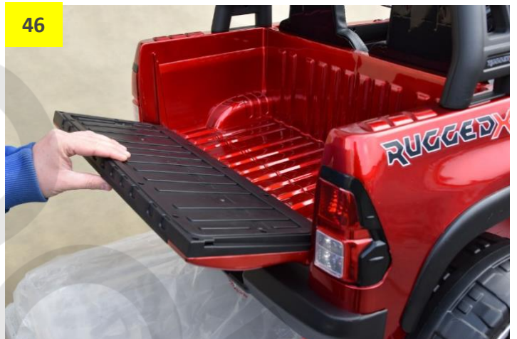
Obr. 45 a 46: Otevírání a zavírání zadního čela. Při otevírání zadní čelo nejdříve povytáhněte směrem nahoru a poté otevřete směrem k sobě.
