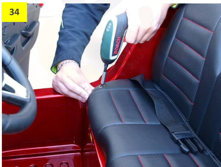
Obr. 33 a 34: Nasadte sedačku, zadní plastové výstupky zasuňte do otvorů v zadní části karoserie. Poté sedačku srovnejte a přišroubujte na levé a pravé straně.
