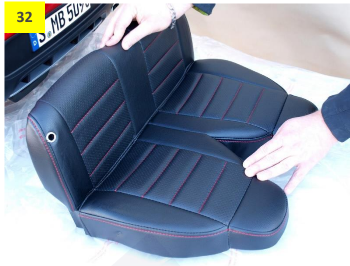
Obr. 33 a 34: Nasadte sedačku, zadní plastové výstupky zasuňte do otvorů v zadní části karoserie. Poté sedačku srovnejte a přišroubujte na levé a pravé straně.
