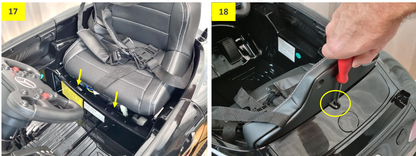
Obr. 17 a 18: Nasadte sedačku. Spodní výstupky v sedačce zatlačte nadoraz do vrchních otvorů v příčce. Sedačku srovnejte a v zadní části přišroubujte.
