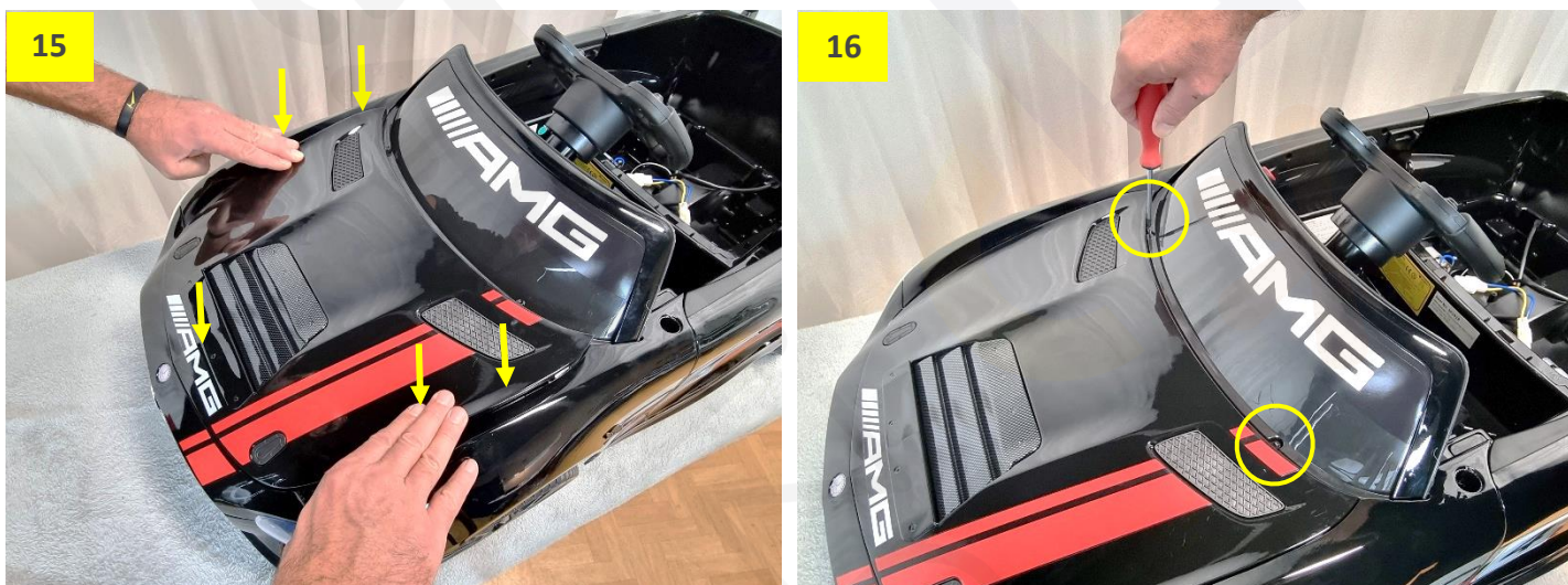
Obr. 17 a 18: Nasadte sedačku. Spodní výstupky v sedačce zatlačte nadoraz do vrchních otvorů v příčce. Sedačku srovnejte a v zadní části přišroubujte.
