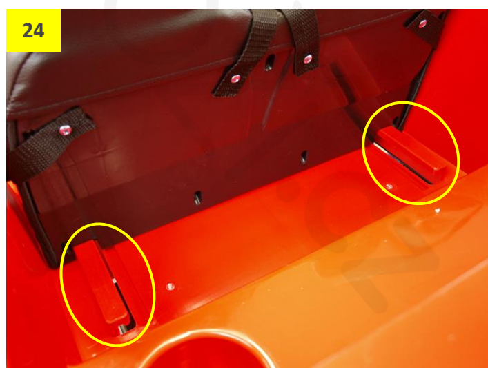
Obr. 24: Sedačku usadíte do vodících lišt, poté strčte ruku pod sedačku a zatlačte nadoraz jisticí tlačítko posunu sedačky. Na hranu sedačky lehce udeřte dlaní, sedačka pak snáze zajede do lišty.
