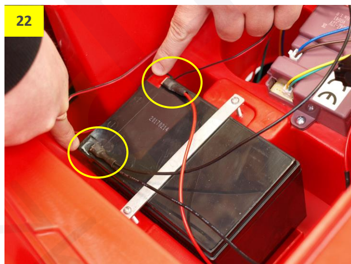
Obr. 22: Zapojení obou baterií: Červený kabel na červené + a černý kabel na černé mínus -
