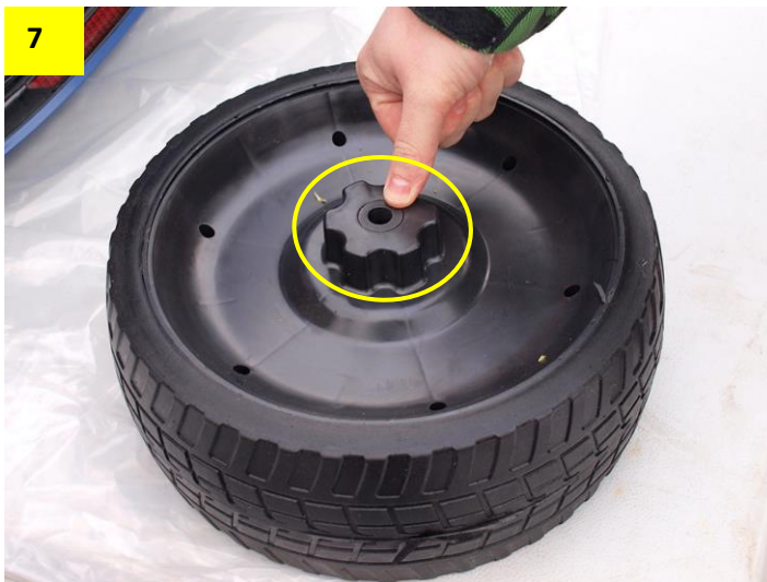
Obr. 9: Ke kolu přiložte 1 až 2 kovové podložky, záleží kolik zbývá volného místa na ose.
