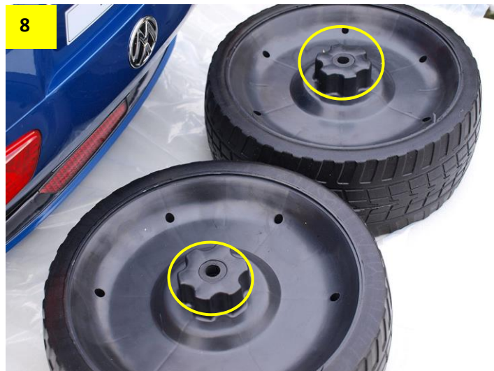
Obr. 9: Ke kolu přiložte 1 až 2 kovové podložky, záleží kolik zbývá volného místa na ose.
