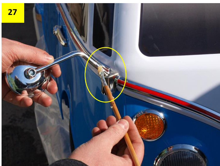
Obr. 28: Nasazení zpětných zrcátek
