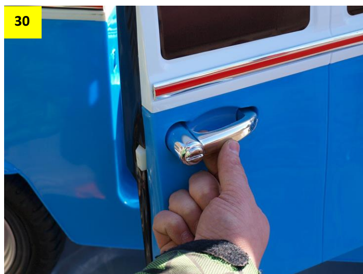
Obr. 29 a 30: Pro otevření dveří je nutné povytáhnout kliku ven. Teprve poté je možné dveře otevřít.
