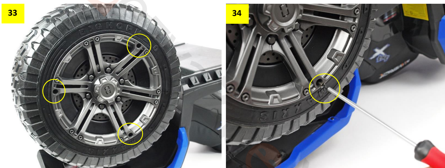
Obr. 34: Na všechna kola nasadte a po té přišroubujte poklice.
