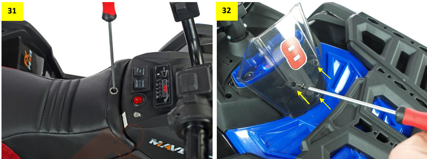
Obr. 32: Nasadte a přišroubujte přední plastový štít.
