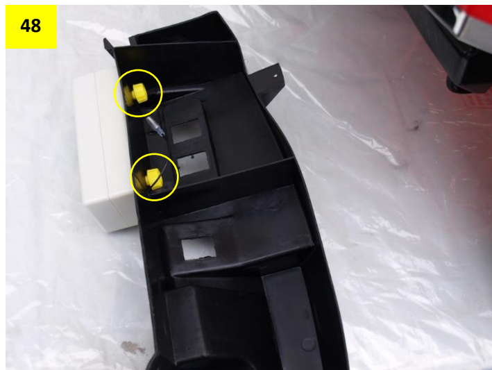
Obr. 47 a 48: Připravte si palubní desku. Do rádia vložte 4 tužkové baterie R6 AA (pozor na správnou polaritu). Následně nasadte zpět kryt baterií a rádio připevněte k palubní desce pomocí vyznačených matic.
