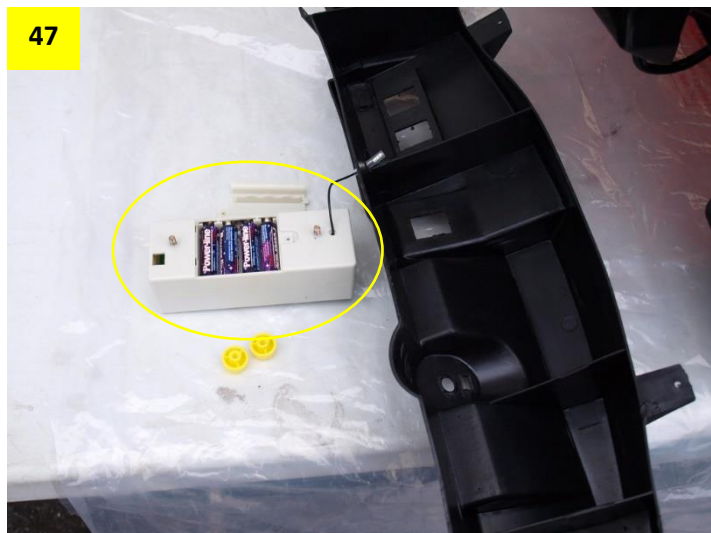
Obr. 47 a 48: Připravte si palubní desku. Do rádia vložte 4 tužkové baterie R6 AA (pozor na správnou polaritu). Následně nasadte zpět kryt baterií a rádio připevněte k palubní desce pomocí vyznačených matic.
