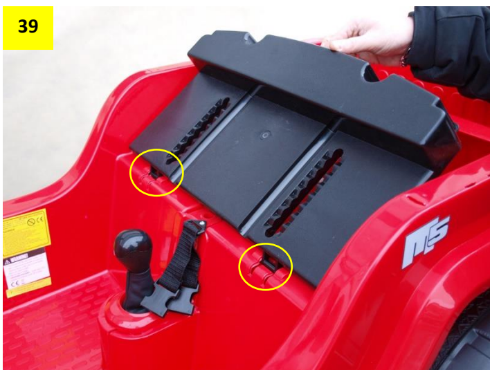
Obr. 40: Zvolte požadovanou vzdálenost sedaček a matice utáhněte.
