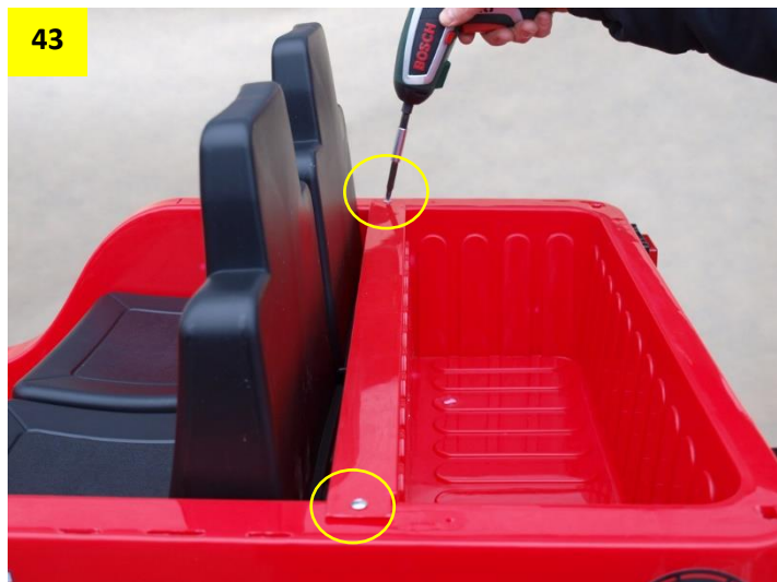
Obr. 44: Nasadte zadní rám a přišroubujte jej.
