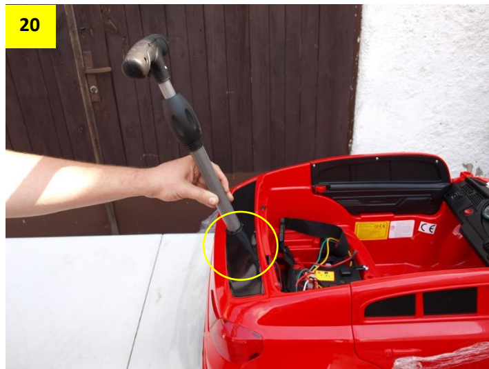
Obr. 22: Rameno táhla zatáčení musí být nasazené přesně jako na obrázku. Pokud jej nasadíte opačně, bude autíčko také opačně zatáčet.
