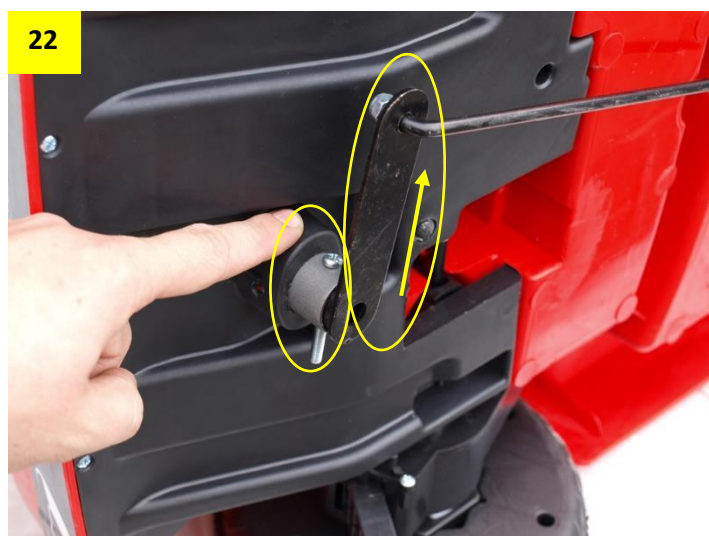
Obr. 22: Rameno táhla zatáčení musí být nasazené přesně jako na obrázku. Pokud jej nasadíte opačně, bude autíčko také opačně zatáčet.
