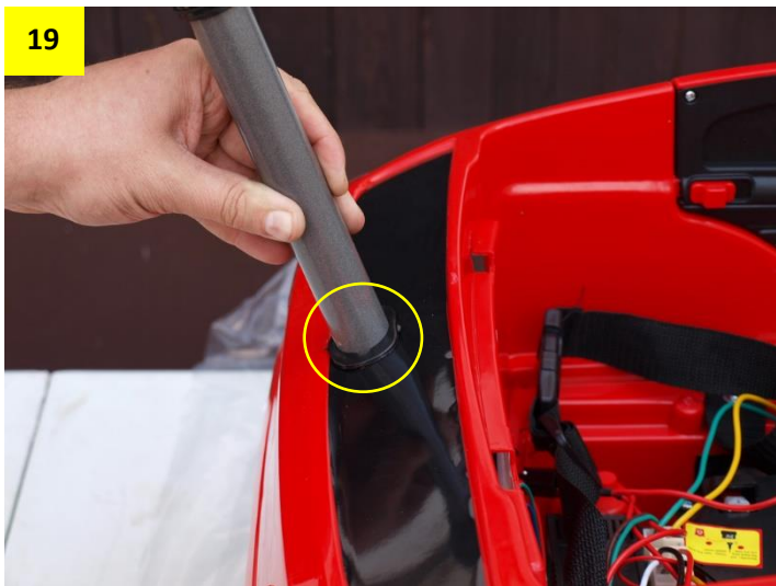
Obr. 22: Rameno táhla zatáčení musí být nasazené přesně jako na obrázku. Pokud jej nasadíte opačně, bude autíčko také opačně zatáčet.
