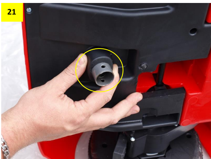
Obr. 22: Rameno táhla zatáčení musí být nasazené přesně jako na obrázku. Pokud jej nasadíte opačně, bude autíčko také opačně zatáčet.
